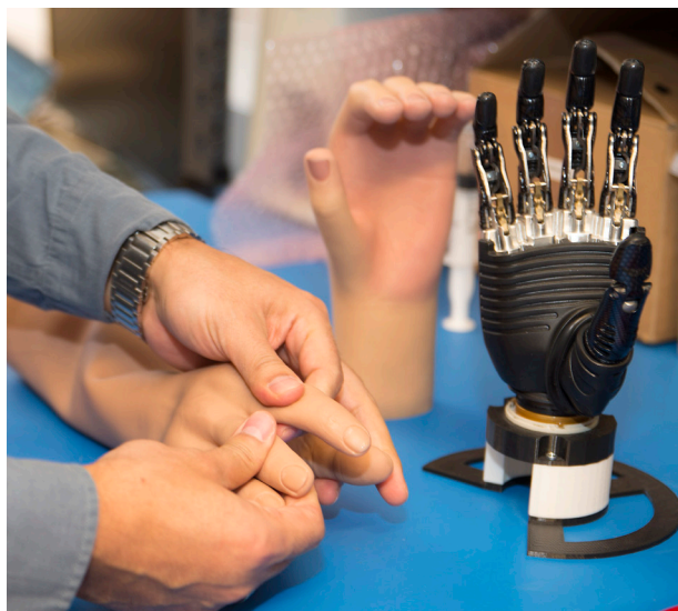
Med en handske i hudliknande material ser protesen mer ut som en vanlig hand. Handsken ökar dock motståndet i protesen och därför föredrar många det mer robotlika utseendet trots allt.
